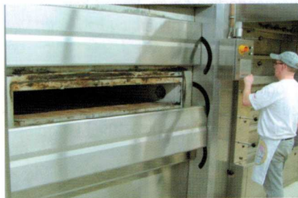
Etagenbackofen, Brennstoff Holzpellets, in Richters Altstadt-Bäckerei.
